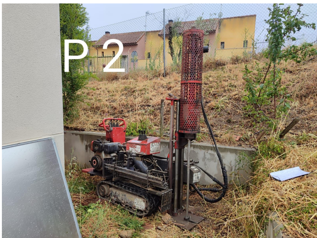
Figura Nº 9.- Trabajos para la realización de la penetración dinámica, tipo DPSH, referida como P-02.
