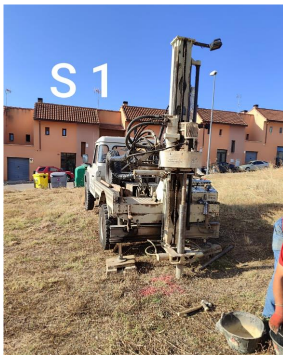
Figura Nº 6.- Imagen de la ejecución del sondeo mecánico y rotativo con extracción continua de testigo referido como S-01.
