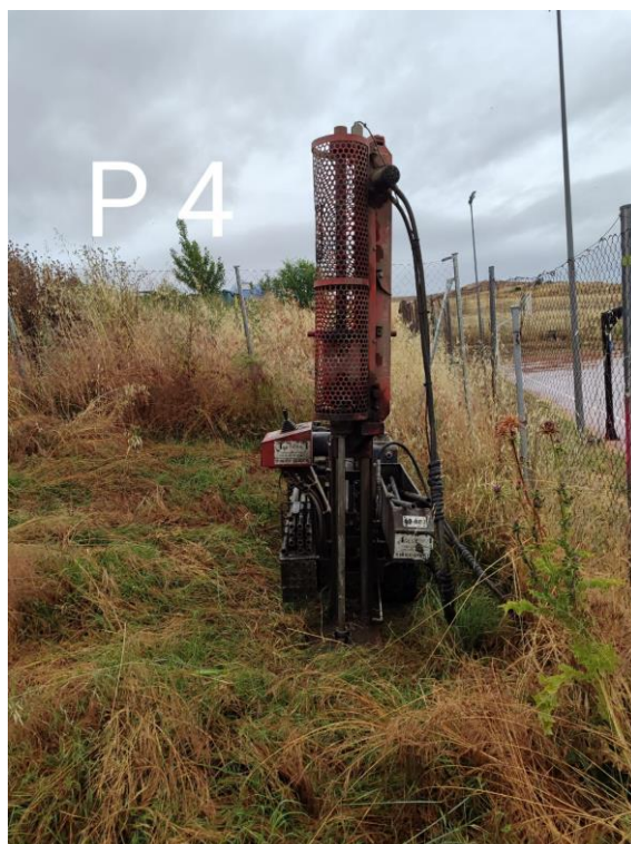
Figura Nº 11.- Trabajos para la realización de la penetración dinámica, tipo DPSH, referida como P-04.
