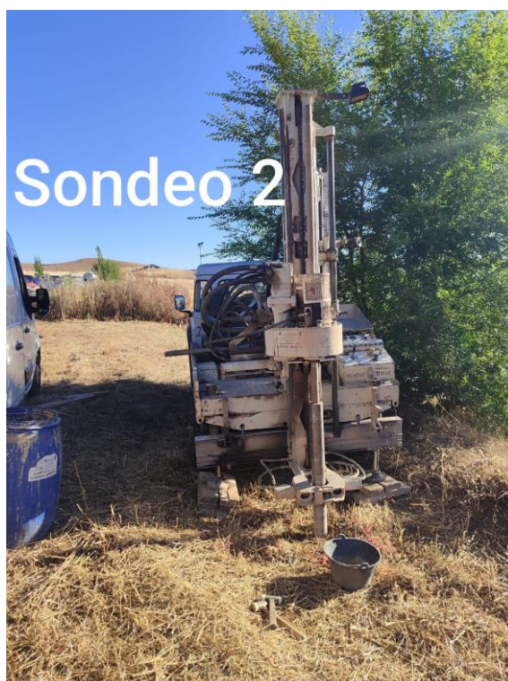
Figura Nº 7.- Imagen de la ejecución del sondeo mecánico y rotativo con extracción continua de testigo referido como S-02.
