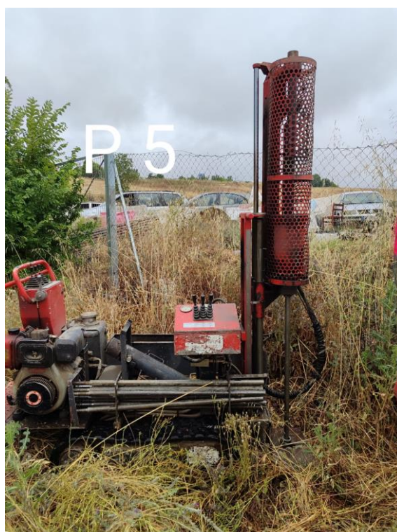
Figura Nº 12.- Trabajos para la realización de la penetración dinámica, tipo DPSH, referida como P-05.
