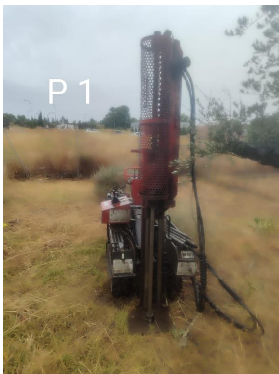
Figura Nº 8.- Trabajos para la realización de la penetración dinámica, tipo DPSH, referida como P-01.
